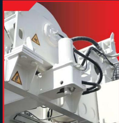
Два гидроцилиндра на поворотной части для удобного монтажа / демонтажа противовесов.
