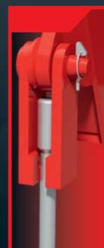
Для крепления каната к стреле вместо коуша применена специальная заделка (стальная втулка). Втулка вкладывается в замок на оголовке стрелы автокрана. С помощью такой заделки канат легко монтируется и демонтируется без переломов, вращается, выводя излишнее кручение и напряжение.
