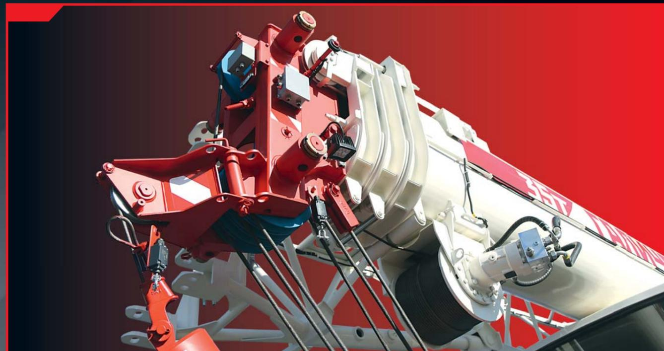
Технология вспомогательной грузовой лебедки, установленной на основной стреле - уникальное конструкторское решение для ускоренного подъема грузов массой до 2,5 т и сохранения транспортных габаритов автокрана по длине равной 12,0 м.
