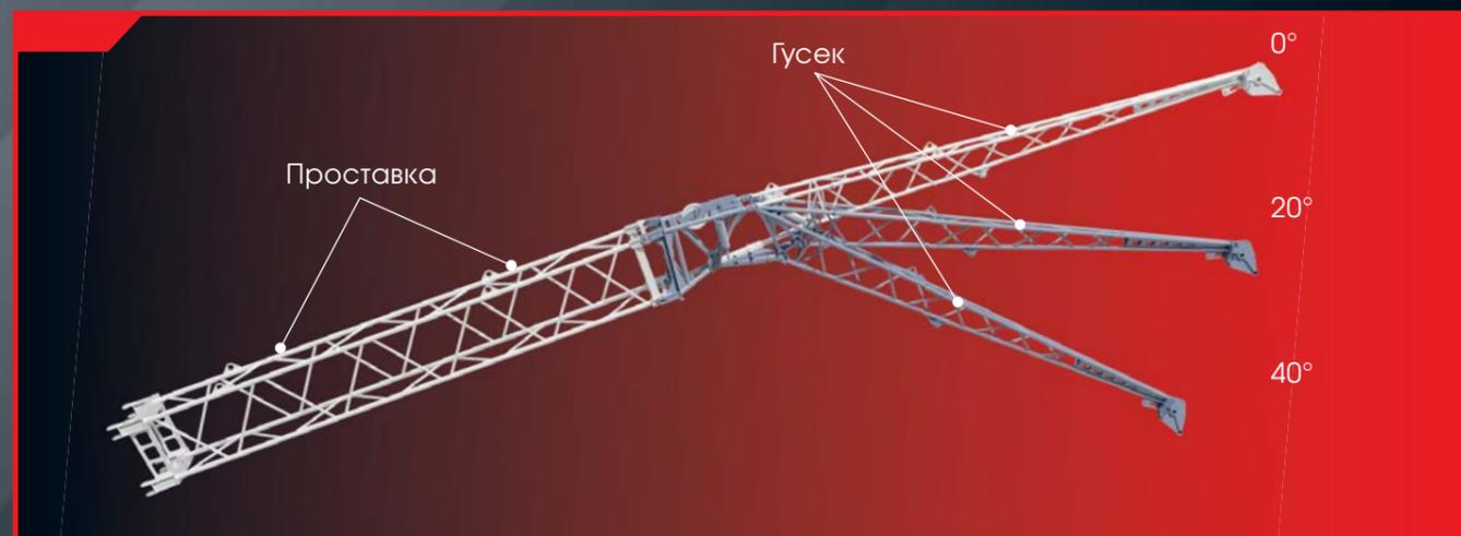
Технология «трансформер» позволяет установить на основную стрелу две дополнительные проставки по 6,0 м и гусёк 9,0 м для увеличения рабочей длины стрелы с 33,2 м до 54,2 м, чтобы подать груз на высоту 18-этажного сооружения.
