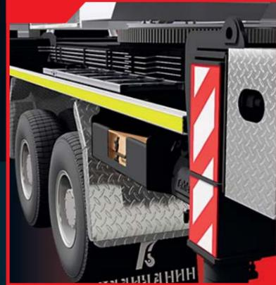
Заниженная высота настила позволяет защитить трубопроводы от повреждений и улучшает доступность. На кране предусмотрены инструментальные ящики под стропы, чалки, подкладки и т.д.
