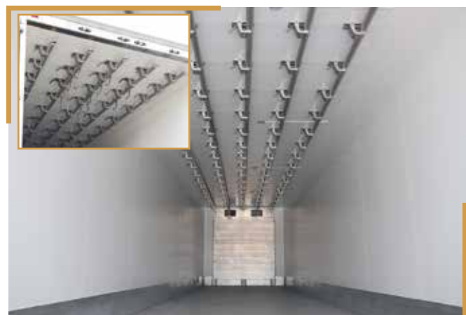
Комплектация с ХОУ, с защитой ХОУ, с системой для перевозки полутоп в подвешенном состоянии
