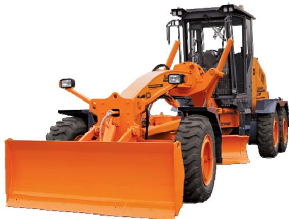
Автогрейдер DM-14.1 с механической коробкой передач предназначен для профилирования и планировки поверхности земляного полотна дорог, площадей, возведения насыпей, разравнивания откосов и перемещения грунта, гравия или щебня. Используется в автодорожном, железнодорожном, аэродромном и гидротехническом строительстве, при очистке дорог и территорий от снежных завалов, при разрыхлении грунта и снятии изношенных полотен дорог.
