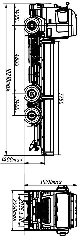
**ТЕХНИЧЕСКИЕ ХАРАКТЕРИСТИКИ****Технически допустимая масса автопоезда, кг.....** 56500**Технически допустимая общая масса автомобиля, кг.....** 26500**Распределение технически допустимой общей массы автомобиля:****на переднюю ось, кг.....** 7500
